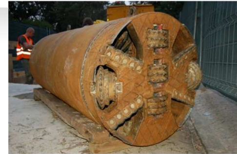
b) Cabeça da microtuneladora
